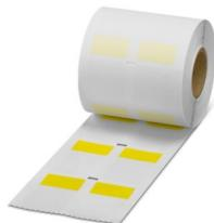
Kabelmarker, bestellbar: zeilenweise, gelb, beschriftet nach Kundenangaben, Kabeldurchmesserbereich: 6,1 ... 14,2 mm, Montageart: kleben, Kabeldurchmesser: ≤ 14,2 mm, Textfeldhöhe: 19 mm, Textfeldbreite: 38 mm
