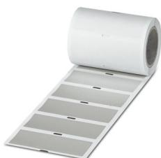
Sicherheitsetikett mit Spezialkleber, bestellbar: zeilenweise, silber, beschriftet nach Kundenangaben, Montageart: kleben, Textfeldhöhe: 32 mm, Textfeldbreite: 85 mm
