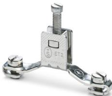
Schutzleiter-Reihenklemme, Anzahl der Anschlüsse: 2, Polzahl: 1, Anschlussart: Schraubanschluss, Querschnitt: 0,5 mm<sup>2</sup> - 16 mm<sup>2</sup>, Montageart: NS 35/7,5, NS 35/15, Farbe: silberfarben
