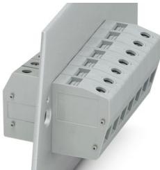
Durchführungsklemme, Anschlussart: Schraubanschluss mit Zughülse, Schraubanschluss mit Zughülse, Polzahl: 1, Belastungsstrom: 76 A, Querschnitt: 0,5 mm<sup>2</sup> - 25 mm<sup>2</sup>, Anschlussrichtung des Leiters zur Steckrichtung: 0 °, Breite: 12 mm, Farbe: grün-gelb
