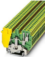
Schutzleiter-Reihenklamme, Doppelanschluss auf jeder Seite, Anzahl der Anschlüsse: 4, Polzahl: 1, Anschlussart: Schraubanschluss, 1. Etage, Querschnitt: 0,2 mm<sup>2</sup> - 6 mm<sup>2</sup>, Befestigungsart: PE-Fuß mit Befestigungsschraube, M3, Montageart: NS 35/7,5, NS 35/15, NS 32, Farbe: grün-gelb
