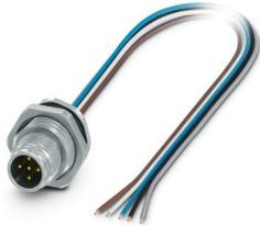
Gerätesteckverbinder Hinterwand, Universal, 5-polig, Stift, gerade, M12-Push-Pull-Außenverriegelung, Kodierung: A, auf freies Leitungsende, Hinterwandmontage, M16 x 1,5, Einzellitzen, Kabellänge: 0,5 m, 0,34 mm<sup>2</sup>, TPE-Litze, vergossen, Artikel ist bleifrei nach RoHS II ohne Ausnahme 6c (Pb < 0,1 %)
