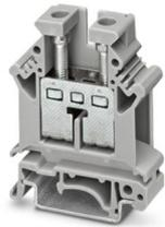
Durchgangsklemme, Nennspannung: 800 V, Nennstrom: 76 A, Anzahl der Anschlüsse: 2, Polzahl: 1, Anschlussart: Schraubanschluss, Bemessungsquerschnitt: 16 mm<sup>2</sup>, Querschnitt: 2,5 mm<sup>2</sup> - 25 mm<sup>2</sup>, Montageart: NS 35/7,5, NS 35/15, NS 32, Farbe: grau
