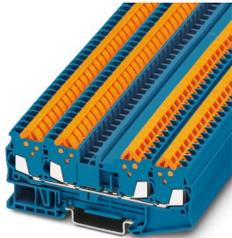
Borne de passagem, tensão nominal: 800 V, corrente nominal: 17,5 A, quantidade de conexões: 4, tipo de conexão: Conexão rápida, Bitola: 1,5 mm<sup>2</sup>, 1. nível, perfil de conexão: 0,25 mm<sup>2</sup> - 1,5 mm<sup>2</sup>, tipo de montagem: NS 35/7,5, NS 35/7,5, cor: azul
