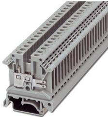
Borne de passagem, tensão nominal: 800 V, corrente nominal: 20 A, 1. Conexão de nível à esquerda, tipo de conexão: Conexão a parafuso, perfil de conexão: 0,2 mm<sup>2</sup> - 4 mm<sup>2</sup>, 1. Conexão de nível à direita, tipo de conexão: Conexão para conector plano, montagem: NS 35/7,5, NS 35/15, NS 32, cor: cinza
