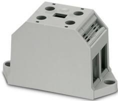
Borne de ligação, tensão nominal: 630 V, corrente nominal: 125 A, quantidade de conexões: 4, número de polos: 1, tipo de conexão: Conexão a parafuso, Bitola: 35 mm<sup>2</sup>, perfil de conexão: 0,75 mm<sup>2</sup> - 35 mm<sup>2</sup>, tipo de montagem: Rosqueamento direto, cor: cinza
