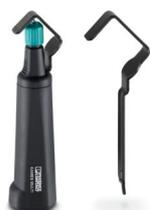
**Ferramenta de decapagem**, para decapar cabos com Ø 4,5 mm - 40-mm, espessura de isolamento até 4,5 mm, lâmina móvel para cortes circulares, longitudinais e espirais
