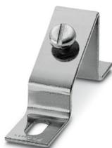
Arco diagonal com parafuso M 6, para fixação dos trilhos de fixação em ângulo de inclinação de 30°, altura: 35,4 mm
