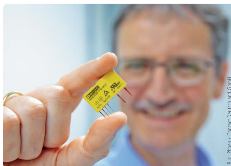
Bild 3: Das zwangsgeführte Elementarrelais NSR bildet das Herzstück der Produktfamilie PSRmini.
