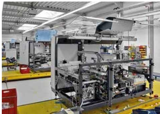
04 Nach jeweils neun Takten à vier Stunden verlässt eine neue Lötanlage die Linienfertigung in Wertheim
