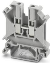
Morsetto passante, tensione nominale: 800 V, corrente nominale: 32 A, numero di connessioni: 2, tipo di connessione: Connessione a vite, Sezione di dimensionamento: 4 mm<sup>2</sup>, sezione: 0,2 mm<sup>2</sup> - 6 mm<sup>2</sup>, tipo di montaggio: NS 35/7,5, NS 35/15, NS 32, colore: grigio
