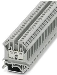
Morsetto passante, tensione nominale: 800 V, corrente nominale: 32 A, numero di connessioni: 2, numero poli: 1, tipo di connessione: Connessione a vite, sezione: 0,2 mm<sup>2</sup> - 4 mm<sup>2</sup>, tipo di montaggio: NS 35/7,5, NS 35/15, NS 32, colore: grigio
