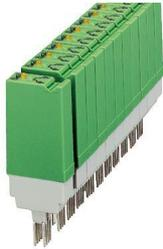
Relè a stato solido di potenza a innesto, con LED e protezione nei circuiti di ingresso e uscita, ingresso: 110 V DC, uscita: 12-60 V DC/max. 1 A, innestabile su morsetti base
