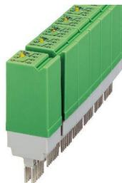
Spina a relè, equipaggiata con relè miniatura, contatti (AgNi): potenze da piccole a grandi, 2 contatti di scambio, tensione d'ingresso 230 V AC/DC, con LED, innestabile su morsetti base
