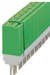
Spina a relè, equipaggiata con relè miniatura, contatti (AgNi): potenze da medie a grandi, 1 contatto di scambio, tensione d'ingresso 230 V AC, con LED, innestabile su morsetti base
