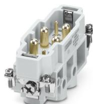
Inserto contatti, numero poli: 4+2+PE, dimensioni: B16, contatti di potenza: 4, contatti di comando: 2, Spina, Connessione a vite, 830 V, 80 A, 1,5 mm<sup>2</sup> ... 16 mm<sup>2</sup>, applicazione: Potenza/segnale
