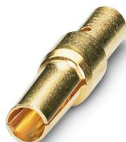
Contatto a crimpare, Femmina, tornito, diametro contatti: 1 mm, sezione di connessione: 0,5 mm<sup>2</sup> ... 1 mm<sup>2</sup>, materiale contatti: CuZn , Prodotto alternativo secondo RoHS II senza eccezione 6c (Pb < 0,1 %) cod. art.: 1244904
