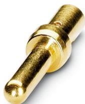
Contatto a crimpare, Spina, tornito, diametro contatti: 1 mm, sezione di connessione: 0,14 mm<sup>2</sup> ..
