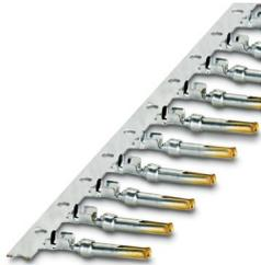
Contatto a crimpare, Femmina, in rotolo, diametro contatti: 1 mm, sezione di connessione: 0,22 mm<sup>2</sup> ... 0,56 mm<sup>2</sup>, materiale contatti: Lega di rame, L'articolo è senza piombo secondo la direttiva RoHS II senza eccezione 6c (Pb < 0,1 %)
