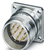
M23, Connettore per apparecchi anteriore, serie: RC, diritto, schermato: sì, Bloccaggio a vite, Numero di poli: 17, Senso di rotazione: standard, tipo di connessione del contatto: Spina, A saldare a mano, Guarnizione piatta, codifica: N, questo articolo dovrebbe essere privo di piombo dal primo trimestre 2026 secondo la RoHS II senza l'eccezione 6c (Pb < 0,1 %), un'alternativa priva di piombo è disponibile in anticipo su richiesta
