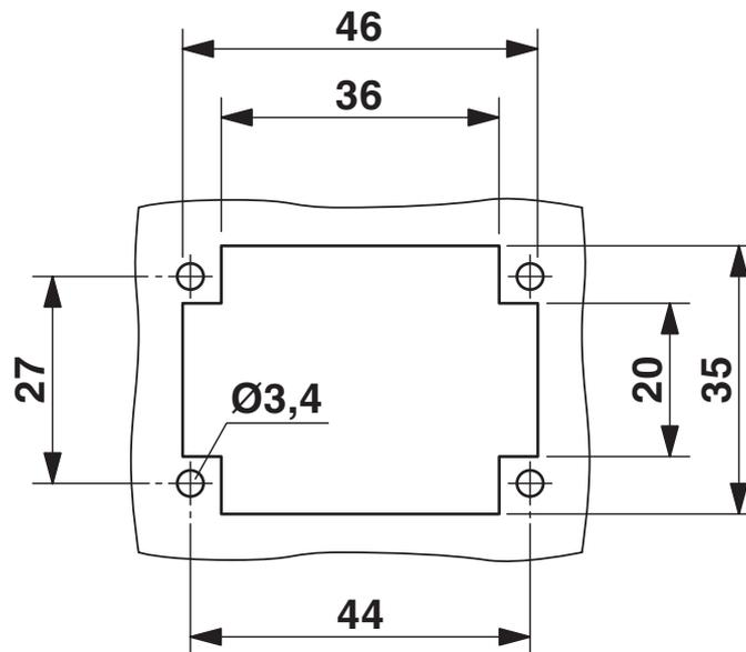
Sezione di montaggio nell'impiego senza custodia
