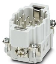
Inserto contatti, numero poli: 10+PE, dimensioni: B6, contatti di potenza: 10, contatti di comando: 0, numero di connessioni per polo: 1, Spina, Connessione Push-in, 500 V, 16 A, 0,5 mm<sup>2</sup> ... 2,5 mm<sup>2</sup>, applicazione: Potenza
