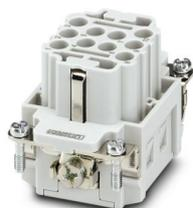
Inserto contatti, numero poli: 10+PE, dimensioni: B6, contatti di potenza: 10, contatti di comando: 0, numero di connessioni per polo: 1, Femmina, Connessione Push-in, 500 V, 16 A, 0,5 mm<sup>2</sup> ... 2,5 mm<sup>2</sup>, applicazione: Potenza
