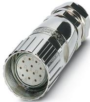
Connettore per cavi, numero poli: 12, segnalazione di stato: no; connessione linea principale: Bloccaggio a vite M23, schermatura: no, questo articolo dovrebbe essere privo di piombo dal secondo trimestre 2026 secondo la RoHS II senza l'eccezione 6c (Pb < 0,1 %), un'alternativa priva di piombo è disponibile in anticipo su richiesta
