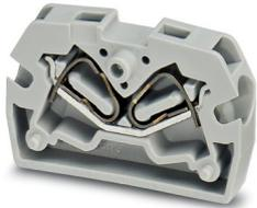
Mini-morsetto con flangia, combinabile con D-MSBV 2,5-F e MSBV 2,5-M, tensione nominale: 800 V, corrente nominale: 24 A, numero di connessioni: 2, tipo di connessione: Connessione a molla, Sezione di dimensionamento: 2,5 mm<sup>2</sup>, 1. piano, sezione: 0,08 mm<sup>2</sup> - 4 mm<sup>2</sup>, tipo di montaggio: avvitamento diretto, colore: grigio
