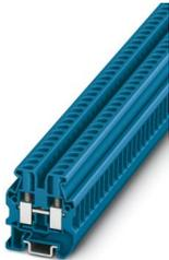
Minimorsetto passante, tensione nominale: 500 V, corrente nominale: 32 A, numero di connessioni: 2, tipo di connessione: Connessione a vite, Sezione di dimensionamento: 4 mm<sup>2</sup>, 1. piano, sezione: 0,2 mm<sup>2</sup> - 6 mm<sup>2</sup>, tipo di montaggio: NS 15, colore: blu
