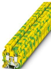
Morsetto per conduttori di terra mini, numero di connessioni: 2, numero poli: 1, tipo di connessione: Connessione a vite, 1. piano, sezione: 0,2 mm<sup>2</sup> - 4 mm<sup>2</sup>, tipo di montaggio: NS 15, colore: giallo-verde
