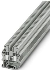
Minimorsetto passante, tensione nominale: 500 V, corrente nominale: 24 A, numero di connessioni: 2, numero poli: 1, tipo di connessione: Connessione a vite, Sezione di dimensionamento: 2,5 mm<sup>2</sup>, 1. piano, sezione: 0,2 mm<sup>2</sup> - 4 mm<sup>2</sup>, tipo di montaggio: NS 15, colore: grigio
