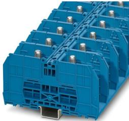
Morsetto di collegamento a bullone, tensione nominale: 1000 V, corrente nominale: 309 A, numero di connessioni: 2, numero poli: 1, tipo di connessione: Bullone, Sezione di dimensionamento: 150 mm<sup>2</sup>, 1. piano, tipo di montaggio: NS 35/7,5, NS 35/15, colore: blu
