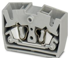
Minimorsetto passante, tensione nominale: 800 V, corrente nominale: 24 A, numero di connessioni: 4, tipo di connessione: Connessione a molla, Sezione di dimensionamento: 2,5 mm<sup>2</sup>, 1. piano, sezione: 0,08 mm<sup>2</sup> - 4 mm<sup>2</sup>, tipo di montaggio: Su piastra di montaggio, colore: grigio
