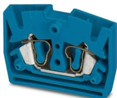
Minimorsetto passante, tensione nominale: 800 V, corrente nominale: 24 A, numero di connessioni: 2, tipo di connessione: Connessione a molla, Sezione di dimensionamento: 2,5 mm<sup>2</sup>, 1. piano, sezione: 0,08 mm<sup>2</sup> - 4 mm<sup>2</sup>, tipo di montaggio: Su piastra di montaggio, colore: blu
