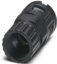
Adattatore per tubi ondulati, con filettatura interna, per la connessione di tubi ondulati a connessioni a vite in plastica HEAVYCON EVO M20 o custodie in plastica ADVANCE M20, diritto, nero, IP66.
