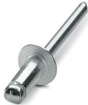
Rivetti ciechi, Ø 4,8 mm, lunghezza guaine 12 mm, guaina in alluminio, punta in acciaio zincata, testa piatta, versione standard secondo DIN 7337 A
