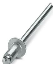
Rivetti ciechi, Ø 3,2 mm, lunghezza guaine 6 mm, guaina in alluminio, punta in acciaio zincata, testa piatta, versione standard secondo DIN 7337 A
