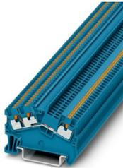
Morsetto passante, tensione nominale: 500 V, corrente nominale: 17,5 A, numero di connessioni: 3, tipo di connessione: Connessione Push-in, Sezione di dimensionamento: 1,5 mm<sup>2</sup>, 1. piano, sezione: 0,14 mm<sup>2</sup> - 1,5 mm<sup>2</sup>, tipo di montaggio: NS 35/7,5, NS 35/15, colore: blu
