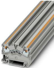
Morsetto passante, tensione nominale: 500 V, corrente nominale: 17,5 A, numero di connessioni: 2, tipo di connessione: Connessione Push-in, Sezione di dimensionamento: 1,5 mm<sup>2</sup>, 1. piano, sezione: 0,14 mm<sup>2</sup> - 1,5 mm<sup>2</sup>, tipo di montaggio: NS 35/7,5, NS 35/15, colore: grigio
