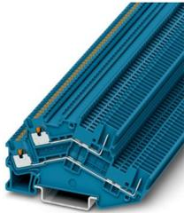
Morsetto a due piani, Corrente e tensione sono determinate dalla spina impiegata., tensione nominale: 500 V, corrente nominale: 16 A, tipo di connessione: Push-in / attacco connettore, 1. e 2. piano, Sezione di dimensionamento: 1,5 mm<sup>2</sup>, sezione: 0,14 mm<sup>2</sup> - 1,5 mm<sup>2</sup>, tipo di montaggio: NS 35/7,5, NS 35/15, colore: blu
