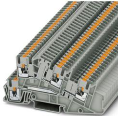
Morsetto di installazione a più piani, Corrente e tensione sono determinate dalla spina impiegata. , tensione nominale: 400 V, Corrente continua termica  $I_{th}$ : 24 A, Connessione Push-in, Sezione di dimensionamento: 2,5 mm<sup>2</sup>, sezione: 0,14 mm<sup>2</sup> - 4 mm<sup>2</sup>, Connessione Push-in, Sezione di dimensionamento: 4 mm<sup>2</sup>, sezione: 0,14 mm<sup>2</sup> - 4 mm<sup>2</sup>, tipo di montaggio: NS 35/7,5, NS 35/15, colore: grigio
