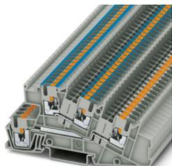
Morsetto di installazione a più piani, tensione nominale: 400 V, corrente nominale: 24 A, Connessione Push-in, 1., 2. e 3. piano, Sezione di dimensionamento: 2,5 mm<sup>2</sup>, sezione: 0,14 mm<sup>2</sup> - 4 mm<sup>2</sup>, Connessione Push-in, tipo di montaggio: NS 35/7,5, NS 35/15, colore: grigio
