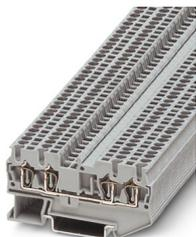
Morsetto passante, tensione nominale: 500 V, corrente nominale: 17,5 A, numero di connessioni: 4, tipo di connessione: Connessione a molla, Sezione di dimensionamento: 1,5 mm<sup>2</sup>, 1. piano, sezione: 0,08 mm<sup>2</sup> - 1,5 mm<sup>2</sup>, tipo di montaggio: NS 35/7,5, NS 35/15, colore: grigio
