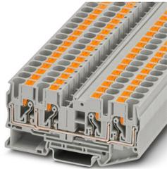
Morsetto passante, tensione nominale: 1000 V, corrente nominale: 41 A, numero di connessioni: 4, tipo di connessione: Connessione Push-in, Sezione di dimensionamento: 6 mm<sup>2</sup>, sezione: 0,5 mm<sup>2</sup> - 10 mm<sup>2</sup>, tipo di montaggio: NS 35/7,5, NS 35/15, colore: grigio
