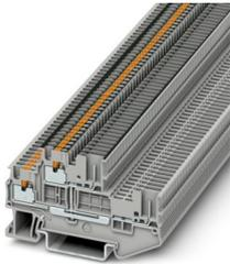
Morsetto passante a due piani, Corrente e tensione sono determinate dalla spina impiegata., con ripartitore di potenziale, tensione nominale: 500 V, corrente nominale: 16 A, tipo di connessione: Push-in / attacco connettore, 1. e 2. piano, Sezione di dimensionamento: 1,5 mm<sup>2</sup>, sezione: 0,14 mm<sup>2</sup> - 1,5 mm<sup>2</sup>, tipo di montaggio: NS 35/7,5, NS 35/15, colore: grigio
