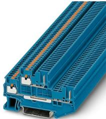
Morsetto passante a due piani, Corrente e tensione sono determinate dalla spina impiegata., tensione nominale: 500 V, corrente nominale: 16 A, tipo di connessione: Push-in / attacco connettore, 1. e 2. piano, Sezione di dimensionamento: 1,5 mm<sup>2</sup>, sezione: 0,14 mm<sup>2</sup> - 1,5 mm<sup>2</sup>, tipo di montaggio: NS 35/7,5, NS 35/15, colore: blu
