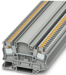
Morsetto passante, tensione nominale: 500 V, corrente nominale: 32 A, numero di connessioni: 2, tipo di connessione: Connessione Push-in, Sezione di dimensionamento: 4 mm<sup>2</sup>, 1. piano, sezione: 0,2 mm<sup>2</sup> - 6 mm<sup>2</sup>, tipo di montaggio: NS 35/7,5, NS 35/15, colore: grigio
