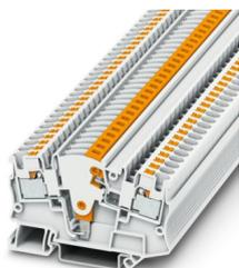
Morsetto sezionatore per conv. misura, tensione nominale: 500 V, corrente nominale: 24 A, numero di connessioni: 2, tipo di connessione: Connessione Push-in, Sezione di dimensionamento: 4 mm<sup>2</sup>, 1. piano, sezione: 0,2 mm<sup>2</sup> - 6 mm<sup>2</sup>, tipo di montaggio: NS 35/7,5, NS 35/15, colore: bianco
