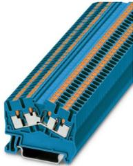
Morsetto passante, tensione nominale: 800 V, corrente nominale: 24 A, numero di connessioni: 4, tipo di connessione: Connessione Push-in, Sezione di dimensionamento: 2,5 mm<sup>2</sup>, 1. piano, sezione: 0,14 mm<sup>2</sup> - 4 mm<sup>2</sup>, tipo di montaggio: NS 35/7,5, NS 35/15, colore: blu
