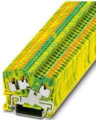
Morsetti comp. per conduttori terra, numero di connessioni: 3, tipo di connessione: Connessione Push-in, 1. piano, sezione: 0,14 mm<sup>2</sup> - 4 mm<sup>2</sup>, tipo di montaggio: NS 35/7,5, NS 35/15, colore: giallo-verde
